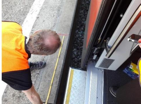
Illustration 9: mesure du delta de la position de l'arrêt
