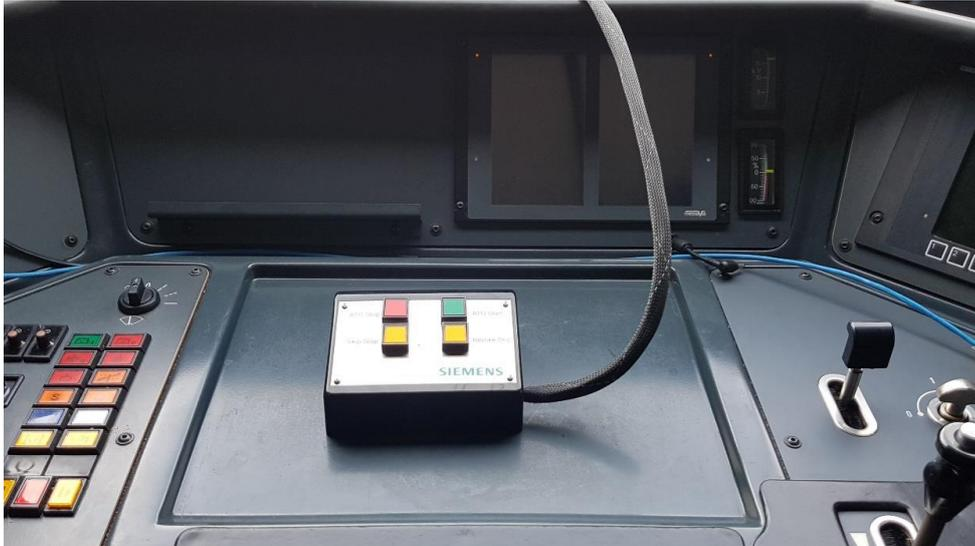
Illustration 6: modèle de fonctionnement «DMI provisoire»
